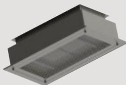
As Caixas Terminais para filtros HEPA – ULPA utilizam estrutura completa em aço INOX AISI 304 soldada. São confeccionadas para atender as especificações e dimensionais de elementos, com vedação por gaxeta contínua. O método de fixação entre filtro e caixa, permite garantia total contra vazamentos estruturais e possibilita a manutenção do filtro pelo interior da sala.
