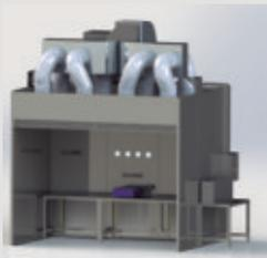
As Cabines de Pesagem e Amostragem - ATEX, garantem ao processo de pesagem e amostragem total segurança através de sua técnica única de forro filtrante passivo, através de conexões de flexíveis acopladas ao duto principal, formando um conjunto único, caracterizado por Fluxo de Ar de Proteção - Unidirecional e Despressurização da área de trabalho.
